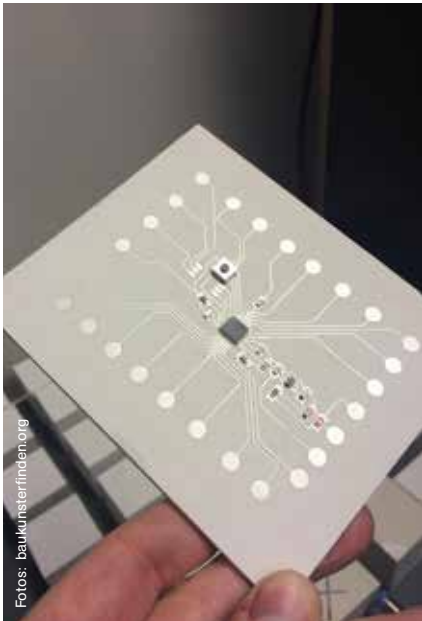
Berührungssensitive Betonoberflächen ermöglichen eine Implementierung von Schaltungen im Beton. Geforscht wird derzeit zu den Möglichkeiten einer funktionsbezogenen Programmierung.
